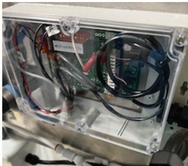
Emplacement des fils de connexion de l'interrupteur à flotteur du boîtier de commande.
